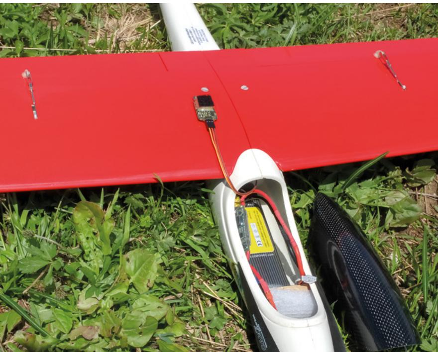
Vor dem Start mit der Funkbake wartet man kurz auf den 3D-Fix des Startortes, was durch ein Doppelblinken angezeigt wird.
